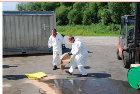
2. Najprej preprečimo nadaljnje izlivanje in omejimo izlito tekočino
